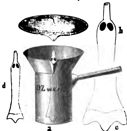
Рис. 267. Кастрюля Д. Цвернера со стеклянною воронкою (d).
