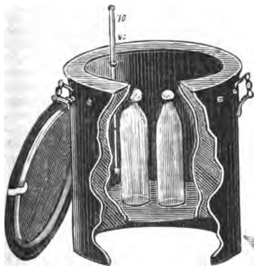
Рис. 270. Пастеризаторъ д-ра Гиппуса. Кастрюлька съ футляромъ, термометромъ, крышкой и бутылками внутри (работы Швабе въ Москвѣ).
