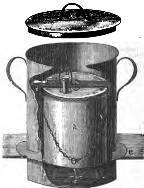
Рис. 265. Стерилизаціонный аппаратъ Эшериха: а—цилиндръ для молока; д—герметически запирающій зажимъ; b—трубка съ ваткою съ открывающимся клапаномъ; c—нижній кранъ для выливанія молока; e—плита.
