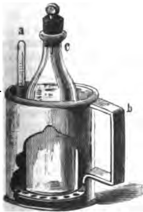
Рис. 260.—Кружка съ двойнымъ дномъ—b для согрѣванія вынутой бутылки—c и термометръ—a.
