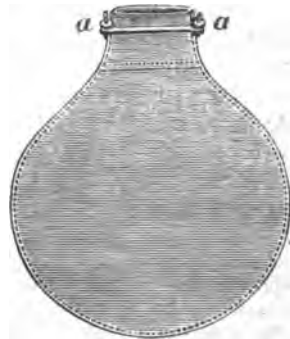
Рис. 152. Плоскій резиновый пузырь для льда: а—мѣдный замокъ (жемъ), запирающій горло мѣшка.
