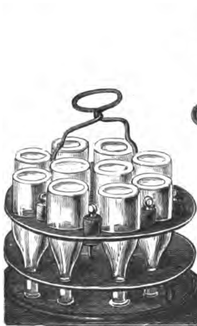
Рис. 258. Штативъ, съ опрокинутыми бутылками и вынутыми пробками.
